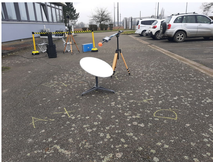
Figure 3 Photographie de la sonde large bande positionnée 50 cm au-dessus de l'antenne Starlink (point S 50 )
